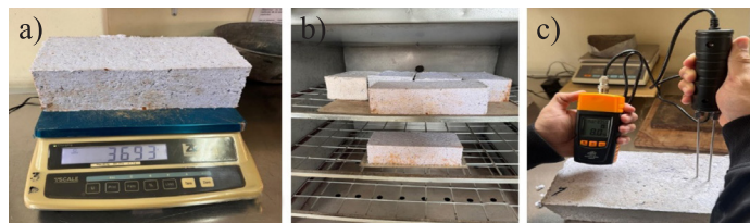
Figura 5. Secuencia de deshidratado de los bloques prensados de papel reciclado. a) Registro de la masa de bloque prensado, b) secado en horno a 60°C y c) verificación de la humedad final con higrómetro de materiales.
