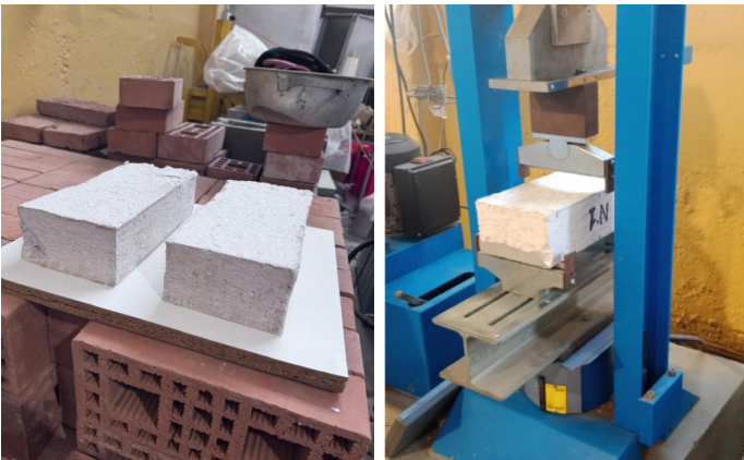
Figura 7. Ensayo de flexotracción de piezas de bloques prensado de papel reciclado prensado.
