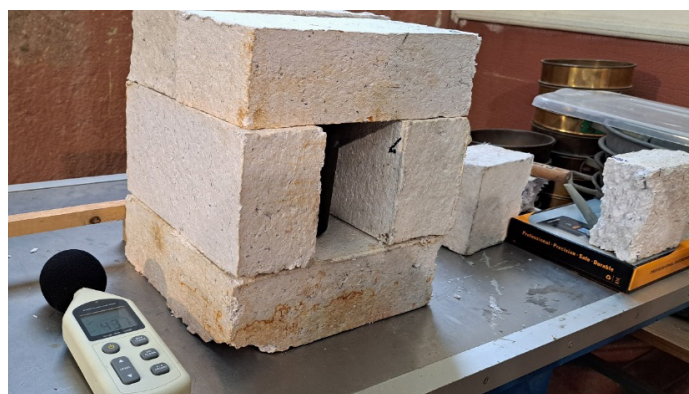
Figura 6. Medición de las propiedades acústicas del bloque de papel.
