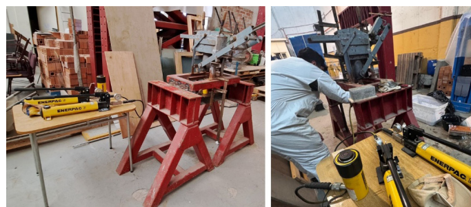
Figura 3. Sistema de prensado para la obtención de bloques prensados de papel reciclado. Está compuesto de prensa Cimva-Ram modificada con adaptación de bomba hidráulica manual.
