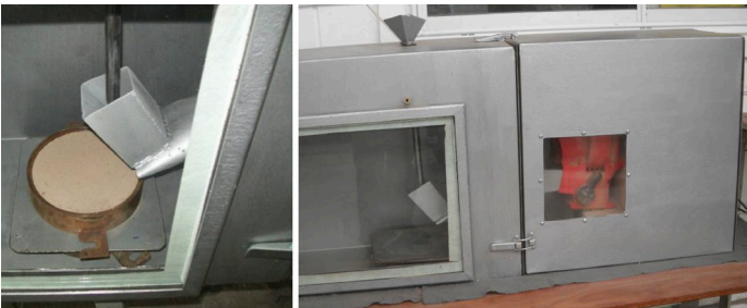
Figura 6: Equipo adaptado por el LEMaC para el control de paliativos de polvo
