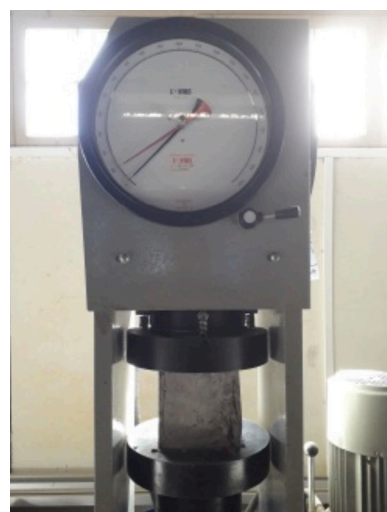
Figura 6: Ensayo a la compresión de probetas de hormigón conteniendo CSFW.
