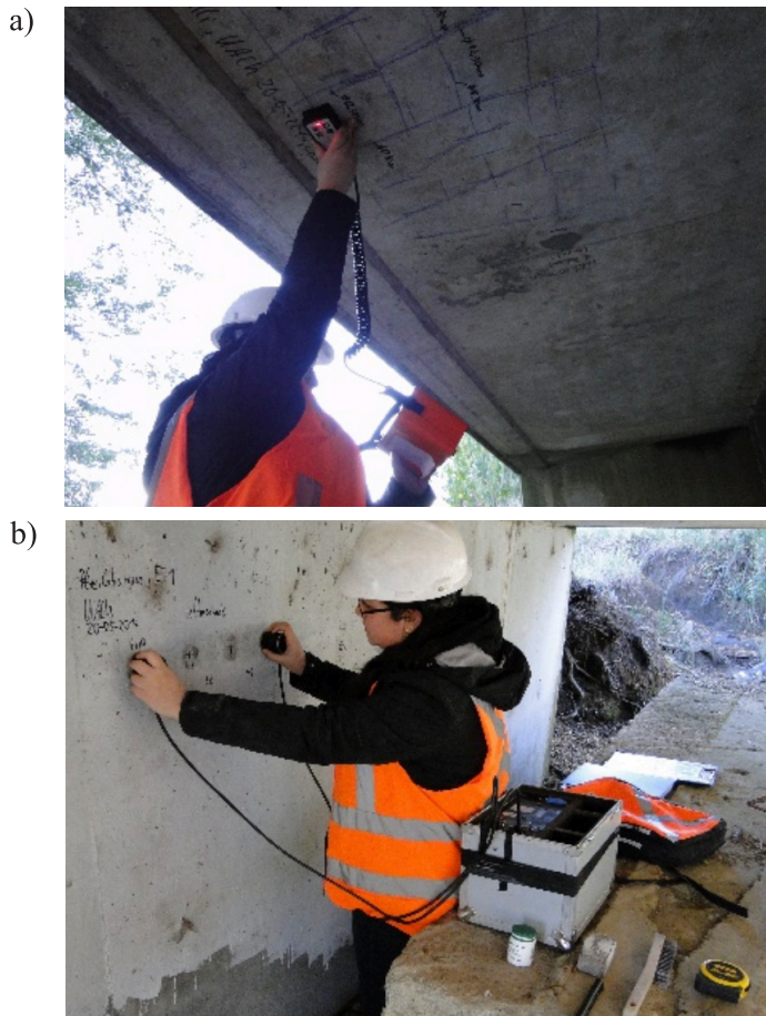
Figura 3: a) Realización del ensayo con Pacómetro en el Puente Trafampulli, Cunco y b) realización del ensayo con ultrasonido en el estribo de hormigón del Puente Caburgua.
