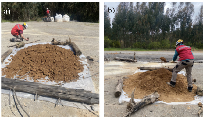
Figura 4: a) Cancha expuesta y b) con material sometido a escarificado manual
