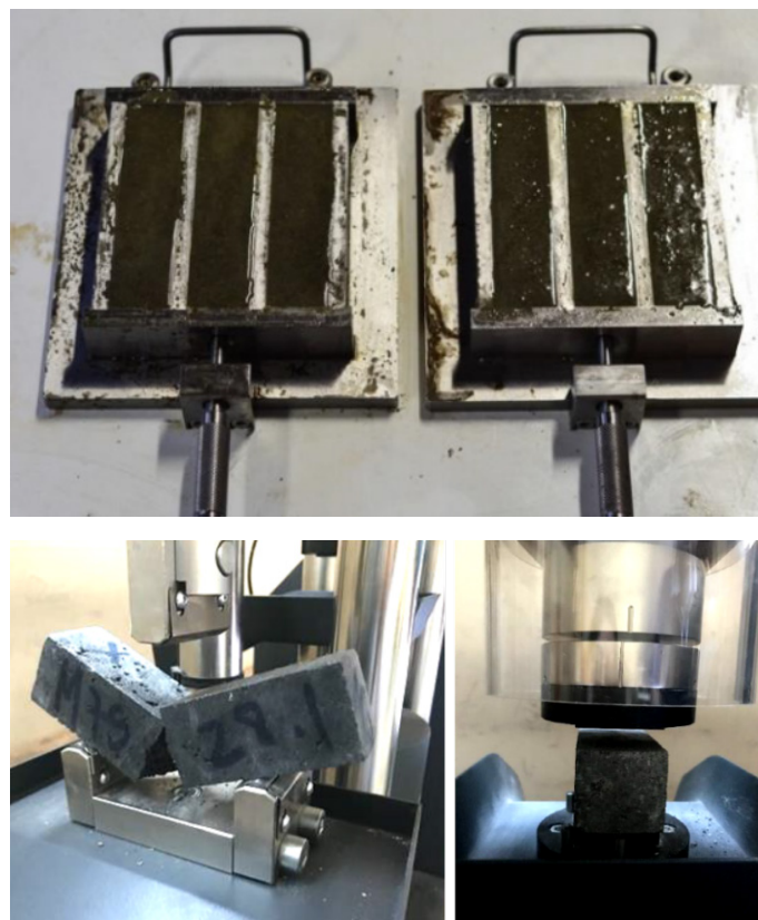
Figura 1. Preparación de muestras y ensayos a flexión y compresión.
