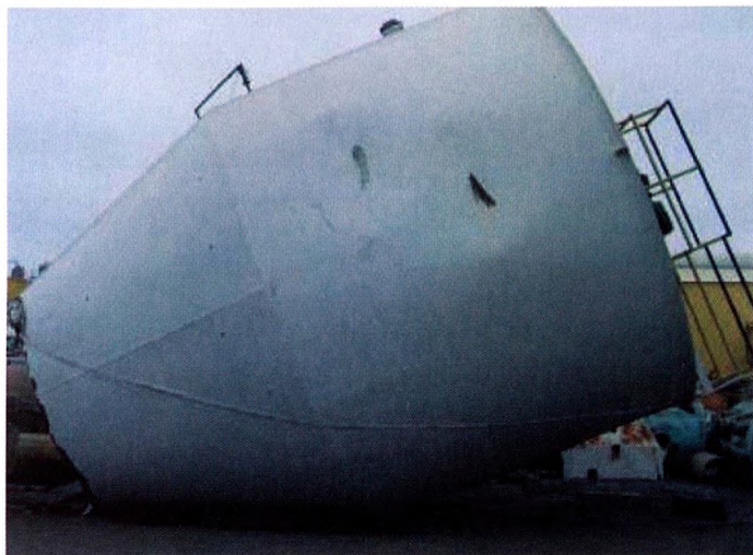
Figura 15: Falla en pila de almacenamiento
