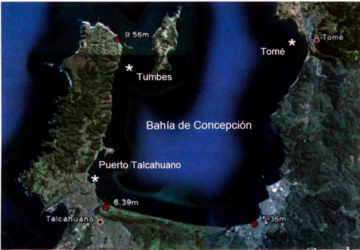
Figura 3: Mediciones de run-up y altura de inundación en la bahía de Concepción, donde * indica la ubicación de mareógrafos virtuales del modelo numérico
