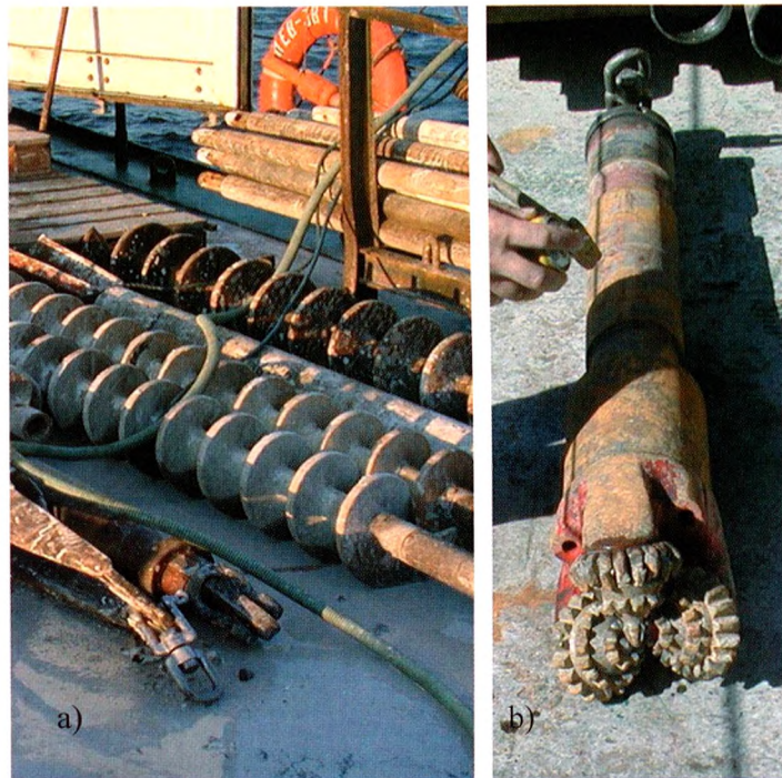
Figura 4: a) Barrenos y b) tubería para fresado
