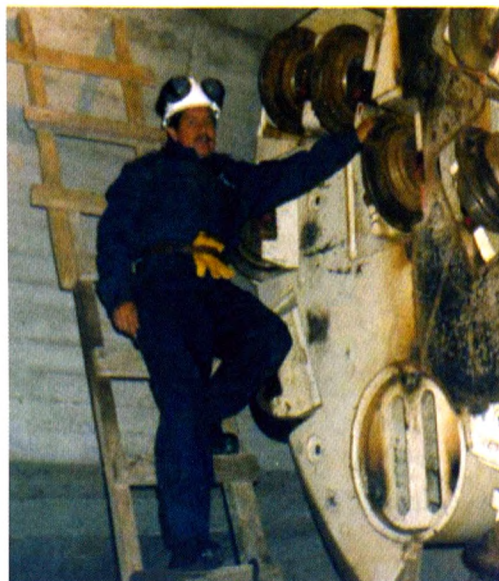
Figura 7: Cabeza de Corte de la TBM en su fase de montaje del Proyecto Yucán, Perú
