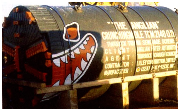
Figura 19: Topo triturador de diámetro similar al empleado en Valparaíso
