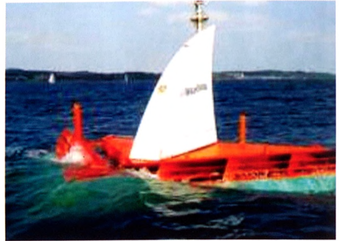
Sistema Flotante de generación en base a oleaje conocido como Waveplane, desarrollado en Dinamarca, cuenta con la particularidad de servir como bomba de oxigenación de agua para profundidades y además genera electricidad. El sistema a sido probado en varias universidades y se encuentra en etapa de desarrollo tecnológico para mejorar la eficiencia del generador y la turbina. www.waveplane.com
