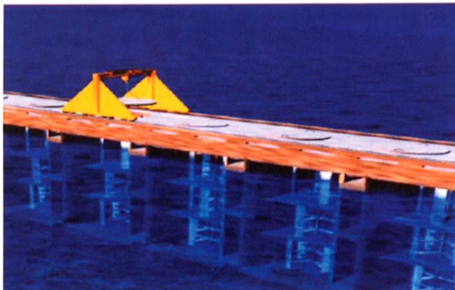
Sistema de generación con turbinas verticales para corrientes marinas diseñado por Blue Energy, Canada. Se han construido sistemas pequeños, prototipo en mayor escala en construcción. www.bluenergy.com
