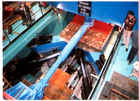
Fig. 20 Prototipo del amortiguador viscoso montado en marco de pruebas [Foto: Cortesía de FIP Industriale, Italia]
