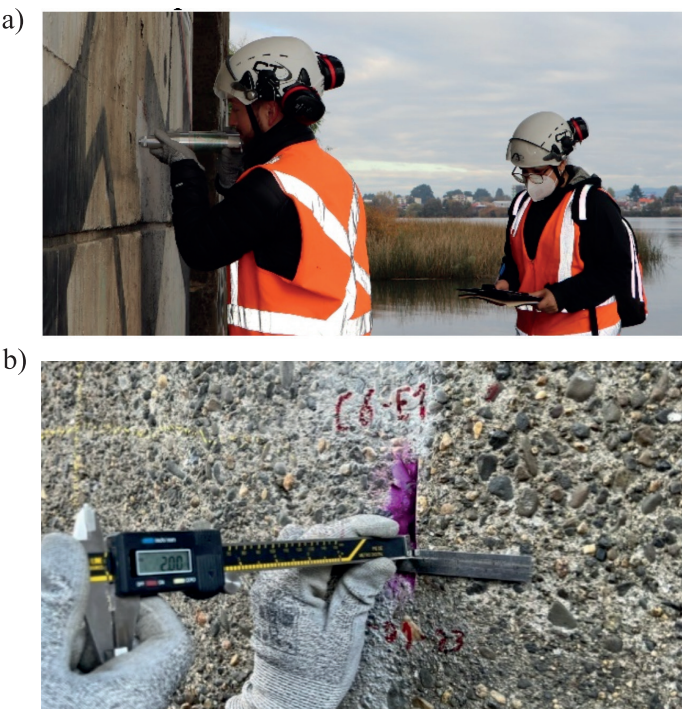
Figura 2: a) Realización del ensayo con esclerómetro en el Puente Calle Calle 1, Valdivia y b) realización del ensayo de carbonatación en el Puente Quinchilca viejo, Los Lagos.
