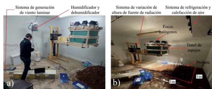
Figura 1: Cámara climática para controlar condiciones de: a) viento y humedad y b) radiación y calor
