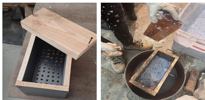
Figura 2. Molde drenante de la pulpa de papel.
